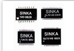
网路变压器 Lan Transformer
